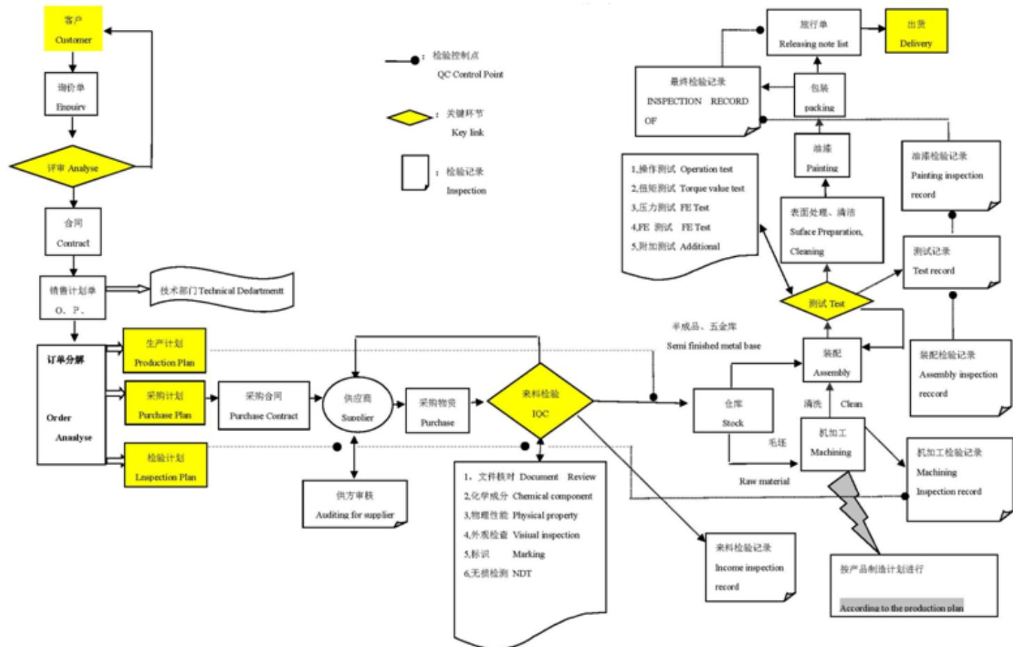
公司按照阀门标准设立有质量网络检测节点，实现检测项目全覆盖，生产过程层层把关。采取定岗定责、过程检查、质量考核、责任追究、质量追溯、数据统计分析等一系列行之有效的方法，做到关键工序重点控制、普通工序规范操作，通过对生产过程的全面控制和对关键节点的有效监督，提高了工作质量，保证了产品质量。
